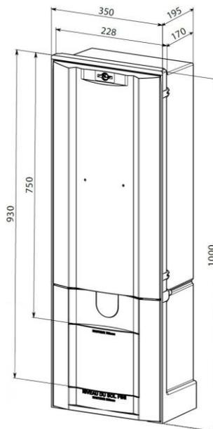
Borne REM BT 300, de couleur beige, équipé d'un support jeu de barres 6 plages, de modules de raccordement, de modules de branchements fusibles, avec embase téléreport et sigle éclair. Spécification technique HN 63-S-65.
