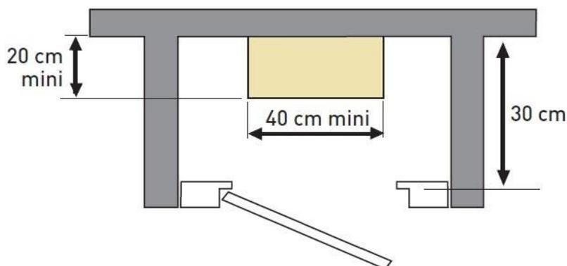
Une plaque d'obturation doit être mise en œuvre sur ce passage de dalle. De même, les fourreaux pour le passage des autres canalisations électriques autorisées seront également obturés.
