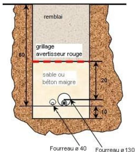
Les fourreaux sont de type TPC rouge annelé, lisse intérieur. Il est usuellement demandé pour la liaison électrique un fourreau  $\varnothing$  110 à 130 mm et un fourreau  $\varnothing$  40 mm pour la liaison du circuit de communication. Ces fourreaux sont enterrés à 60 cm minimum et il est conseillé de les enrober de béton sous les voies ouvertes à la circulation automobile. Un dispositif avertisseur rouge est déroulé à environ 20 cm au-dessus des fourreaux.
