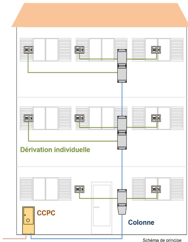
La colonne simple peut être de technologie 200A ou 400A. Le coupe circuit principal collectif (CCPC) est dans un coffret extérieur ECP 2D, accessible directement depuis le domaine public sans franchissement d'accès contrôlé.
